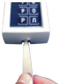
2. Séparer le clavier radio et le support de fixation.
