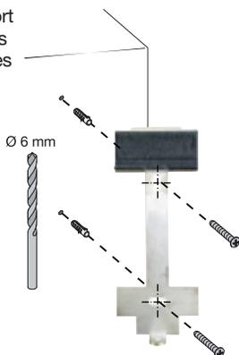
3. Accrocher le clavier par le haut sur le support de fixation et le plaquer.
