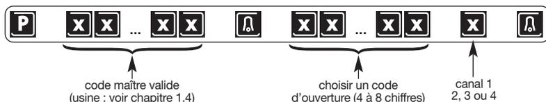
**Exemple**, pour programmer le code (ex. : 1234) pour une **ouverture totale de votre automatisme n° 1** (correspond au canal 1), composer sur les touches de votre clavier :
