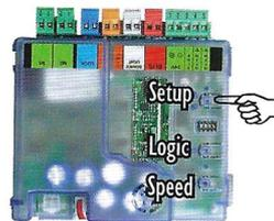
Appuyer sur le bouton «**SETUP**» jusqu'à allumage fixe (SETUP automatique) des voyants «**SETUP**» A et B.
