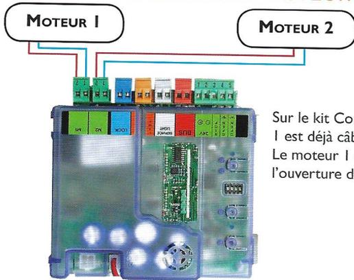
Sur le kit Compas, le moteur 1 est déjà câblé. Le moteur 1 commande l'ouverture du 1<sup>er</sup> vantail.
