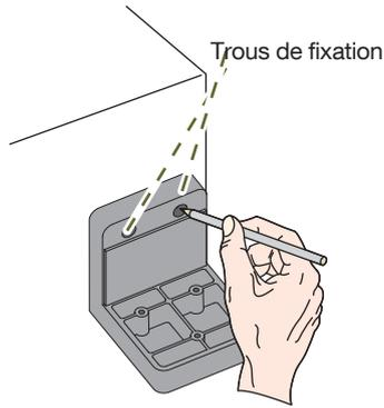
2. Seulement en cas de pilier/mur en **maçonnerie pleine, ou béton, ou acier plein** : retirer le support vertical et percer 2 trous de fixation.
