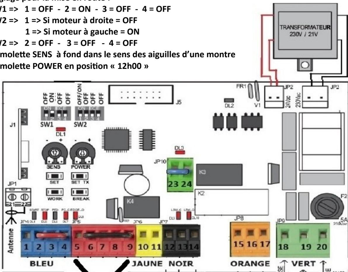
**Pour la mise en service rapide, brancher un fil entre les bornes 5 et 9**
