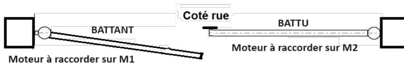
Le « BATTANT » s'ouvre en premier et se referme en dernier. (NB : si c'est un portail avec 1 seul battant, on utilise le bornier M1)
