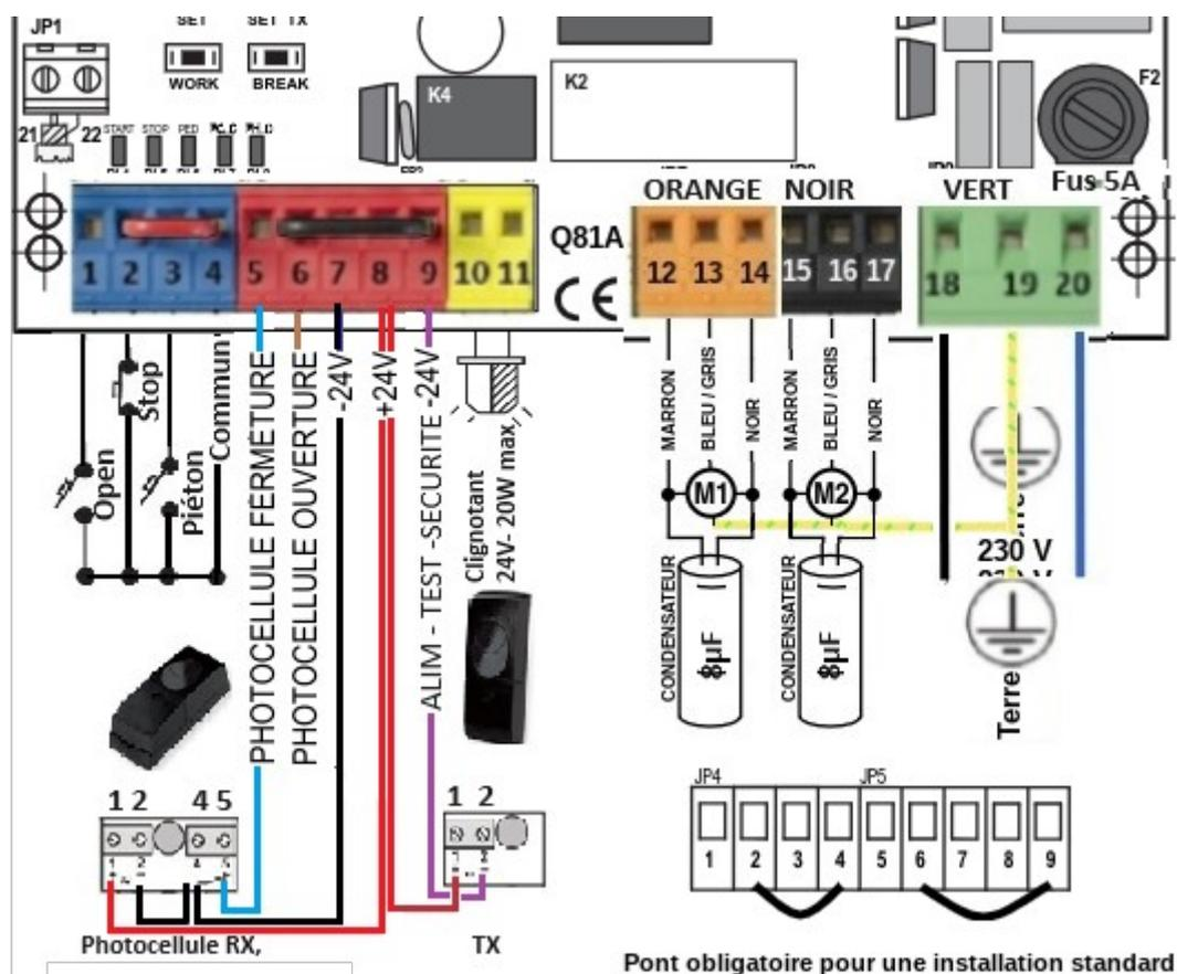
**9° Détail du branchement des accessoires :****9-1° Branchement des photocellules en sécurité à la fermeture :**
