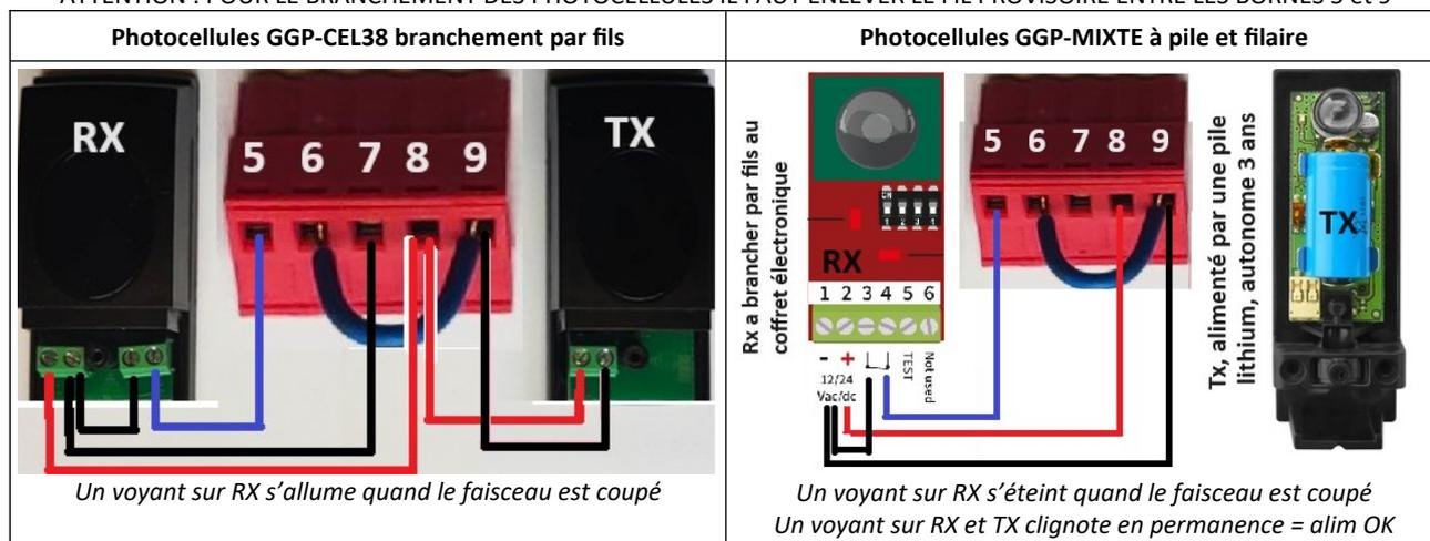
Contrôle : En passant la main devant le faisceau entre les 2 photocellules la Led **PC.C** sur la carte électronique, s'éteint.**9-2° Branchement des fils pour les commandes d'ouverture total et d'ouverture piéton :**
